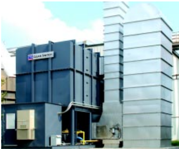
Unidade de 70 000 Nm 3 /h com câmara colectora de COV.
